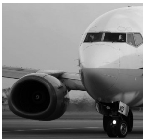
図3 737-500のおむすび型の吸気口
